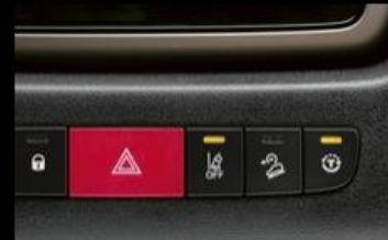
Traction+ „intelligentes“ Elektronikdifferenzial und Hill Descent Control
