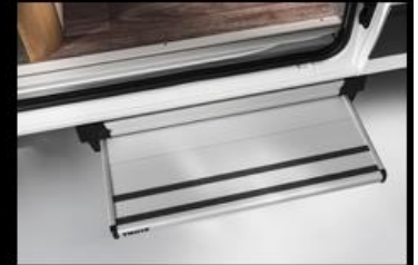
Einstiegsstufe mit elektr. Ausfahrfunktion
